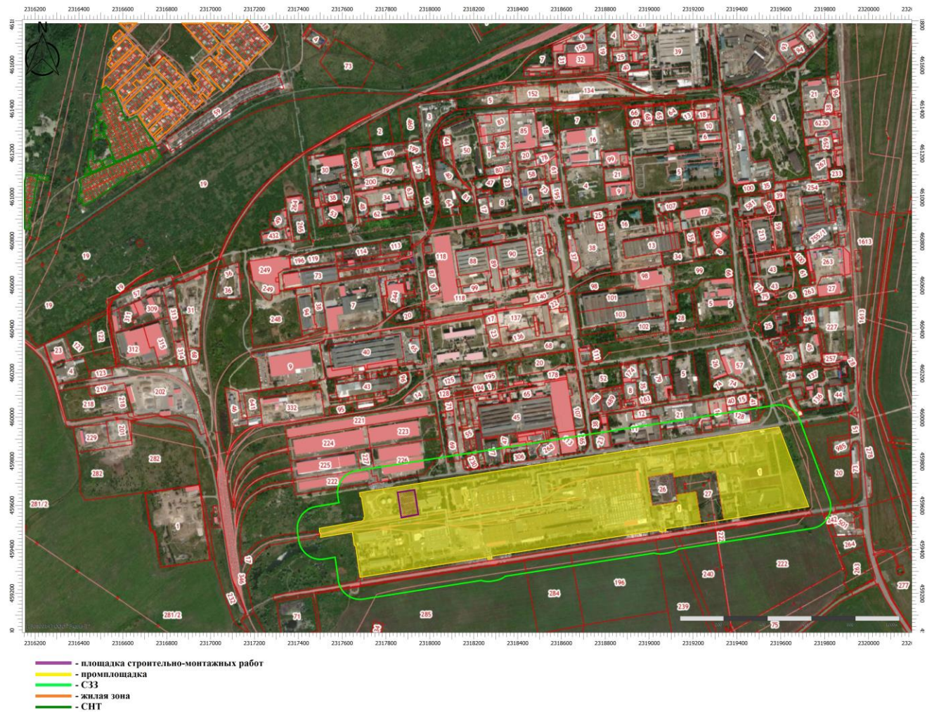
Лист 4 - Ситуационная карта-схема района строительства с указанием границ земельного участка, участка размещения капитального строительства, санитарно-защитной зоной предприятия и нормируемыми территориями
